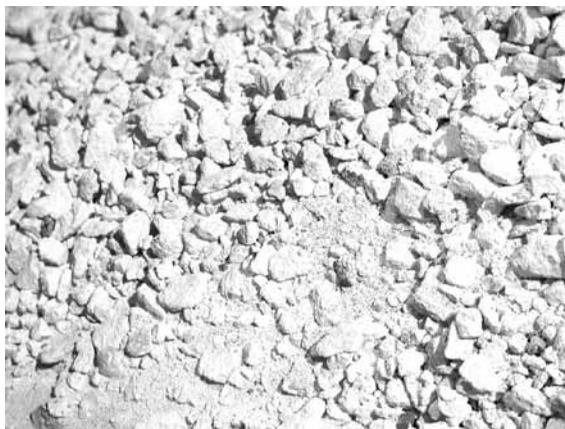
Рис. 2 Негашёная известь специального назначения - мягко обожжённая (фракция 0 – 20 мм)
