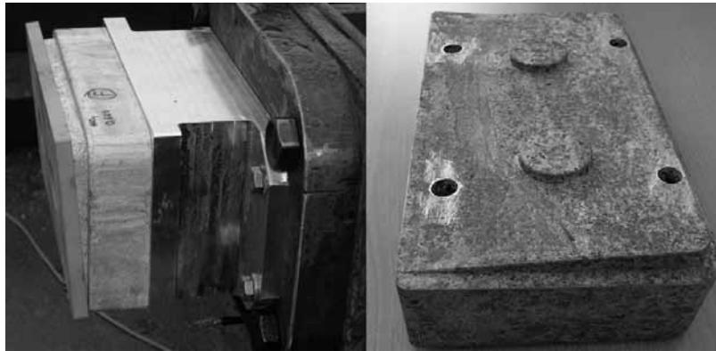
Рис. 1 Амортизационный узел железнодорожного вагона с пеноалюминием (слева) и его компоненты.
