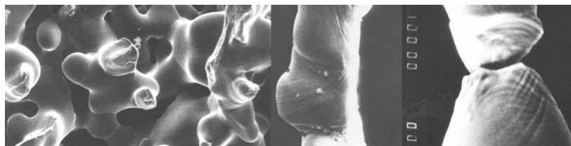
Рис. 7. Изображения зоны разрушения: общий вид (x1000), удлиненная спекённая зона шейки (x10000), разрушенная шейка (x10000) (СЭМ)
