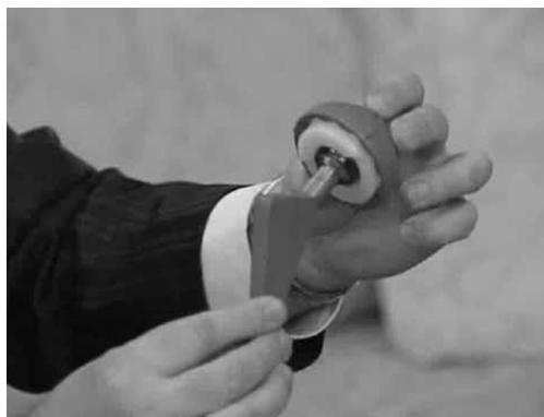
Рис.3. Имплант тазобедренного сустава после МДО-обработки
