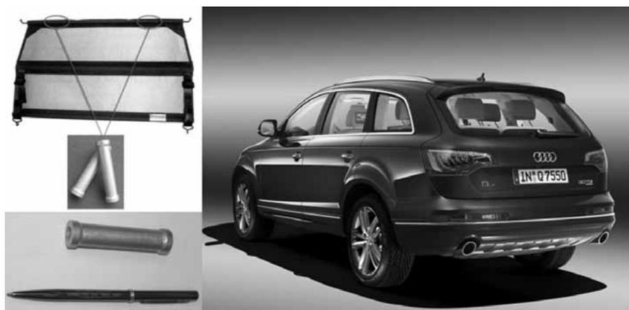
Рис.2 Аварийный амортизатор энергии на основе пеноалюминия в разделительной сетке Audi Q7.
