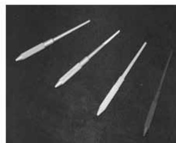
*Рис.1. Медицинструмент, подвергнутый ИЛМ.*
