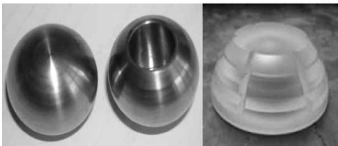
Рис. 6. Образцы титановой головки и сапфировой чашки для эндопротеза тазобедренного сустава
